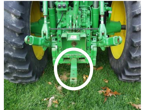
Figura 5.1.c. La barra de remolque del tractor es el único lugar seguro para conectar una carga. No enganche más arriba de la barra de remolque, para que todas las fuerzas se mantengan por debajo de la fuerza de gravedad del tractor. Para la mayoría de las operaciones, la barra de remolque debe de estar en un punto medio entre las llantas traseras, para maximizar el poder de jalar. Las operaciones en inclinaciones, podrían requerir ajustes a un lado de la barra, para balancear las fuerzas que jalan.
