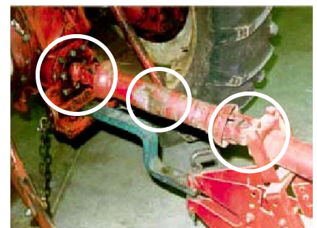
Figura 5.4.1.d. Un protector de eje (o flecha) doblado no ofrece ninguna protección a un eje (o flecha) rotatorio. Note también la falta de un escudo maestro y la protección inadecuada de la unión universal cerca del pedestal del eje (o flecha) de la toma de fuerza.
