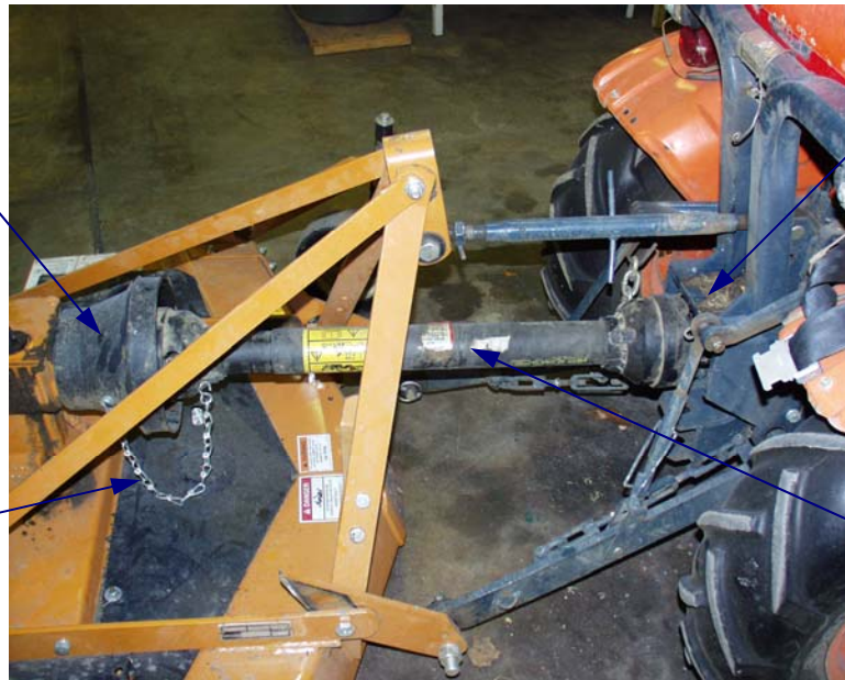
Figura 5.4.1.c. Los protectores más importantes del sistema del eje (o flecha) de la toma de fuerza (PTO).
