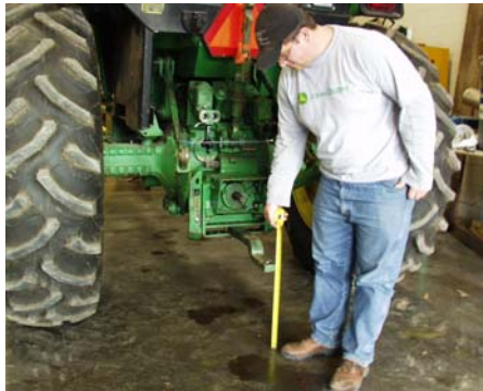
Figura 5.1.d. Las barras de remolque de los tractores están diseñadas a la altura correcta del suelo, para mantener las fuerzas que jalan por debajo del centro de gravedad. Ver Tabla 5.1.a. Use solamente la barra de remolque para remolcar una carga. Las barras de remolque que flotan o se mueven, permiten ajustes a la línea central de empuje, para mantenerse balanceada en terrenos inclinados.
